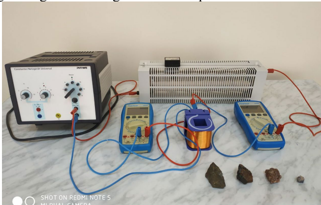
1-rasm. Tog' jinsining magnit singdiruvchanligini aniqlash tajriba ishi.
