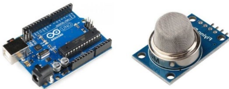
1-rasm. Arduino UNO platformasi va MQ-5 turidagi gaz sensori.
